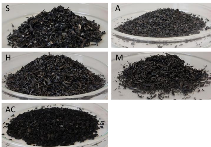
Abbildung 1: Biokohle aus Sonnenblumenkernschalen (S), Marillenkernen (A), Holzschnitzel (W) und Miscanthus (M) und das Referenzfiltermaterial Aktivkohle (AC) Photo: Fridjof Sobanski
