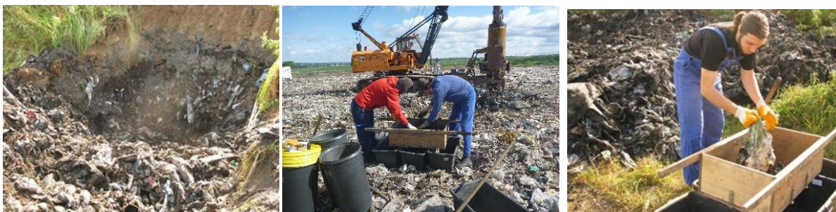
Abbildung 1: Probenahme mittels Schürf (links) und Bohrung (Mitte) sowie Probenaufbereitung mittels Rüttelsieb zur Abtrennung des nicht reaktiven Materials (rechts)
