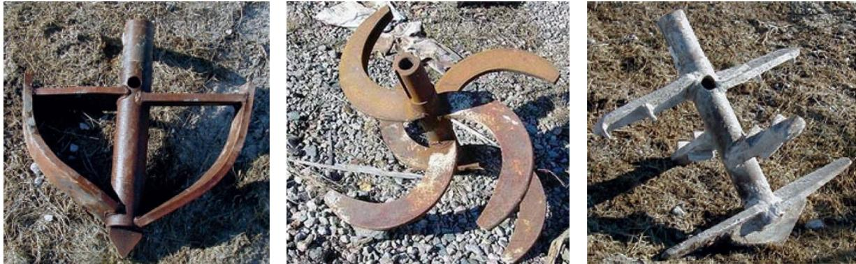
**Abbildung 6:** Formen des Mischwerkzeuges in Abhängigkeit des Bodens
