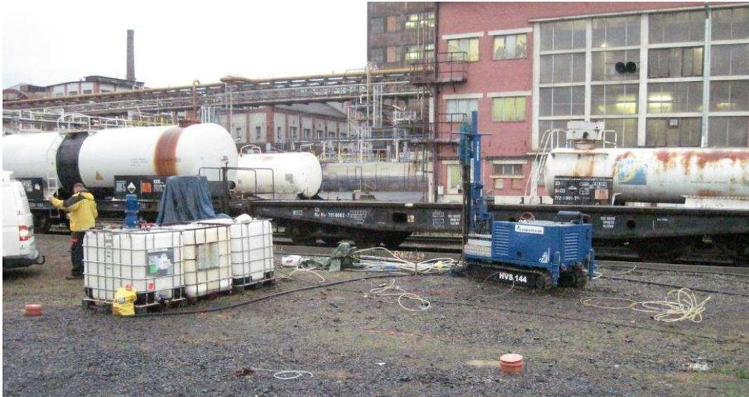
**Abb: Feldversuch: Injektion von Eisenoxidpartikeln am Standort Spoilchem, Ustin.L. (CZ)**
