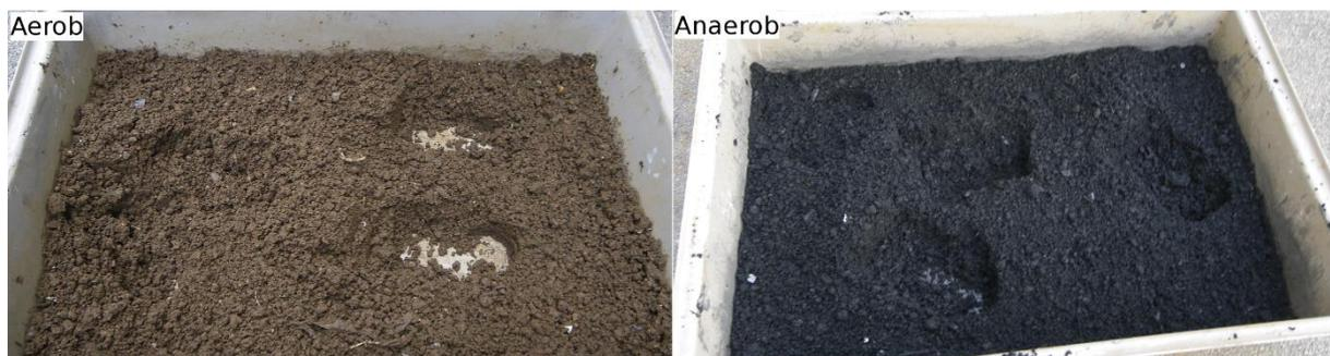
**Bild 2: Material am Ende der Belüftungsversuche**
