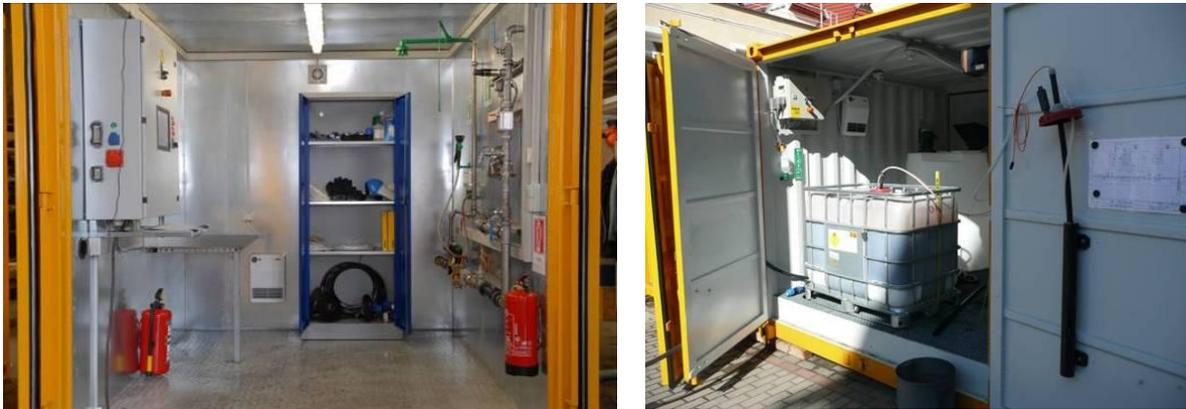
Abb. 6: Mobile in-situ Versuchsanlage zur raschen und sicheren Durchführung von ISCO-Pilotversuchen.
