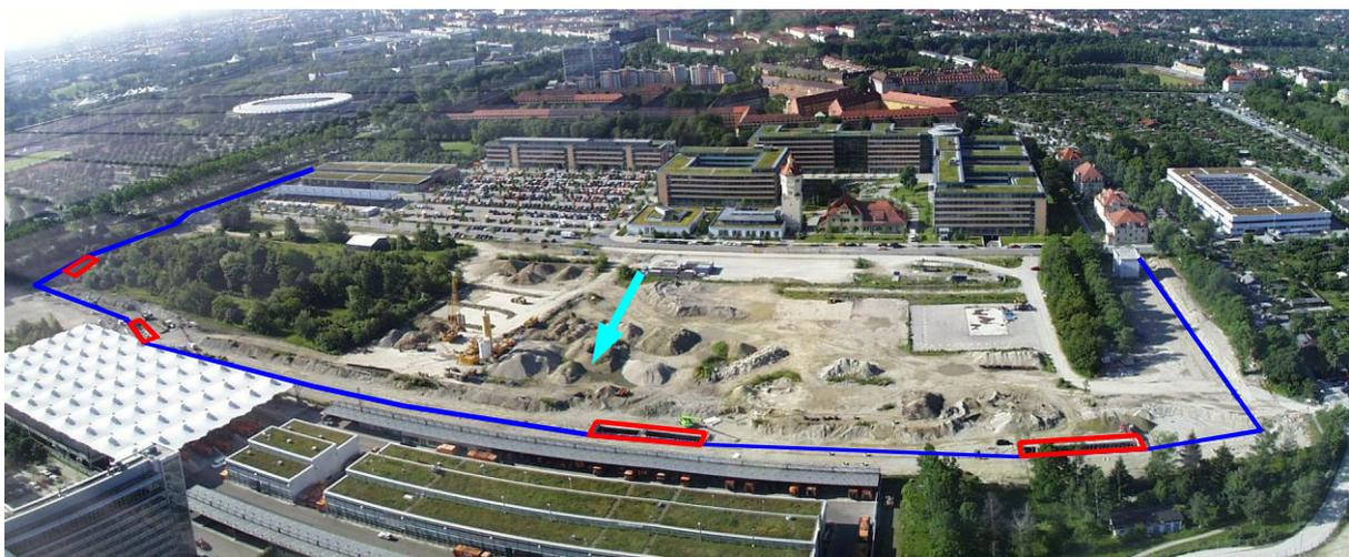
Abbildung 1: Blick von Norden auf das ehemalige Gaswerksgelände mit Lage von Funnel (blau) und Gates (rot) sowie Grundwasser-Fließrichtung (Pfeil)
