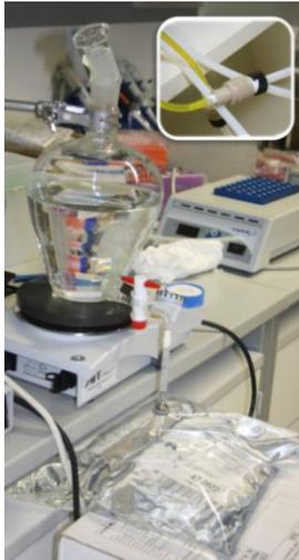
Abb. 1: Vorbereitung der TCE-Lösung in Tedlar-Säcken. Im Insert ist eine Schlauchkopplung zu sehen.
