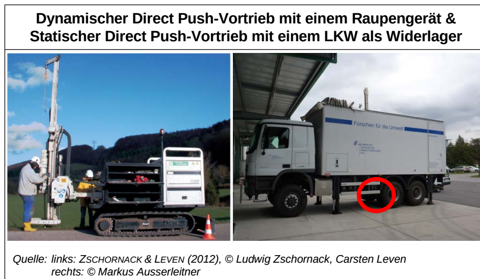
Abbildung 1: links: Dynamischer Direct Push-Vortrieb mit einem Raupengerät; rechts: Statischer Direct Push-Vortrieb mit einem LKW als Widerlager.
