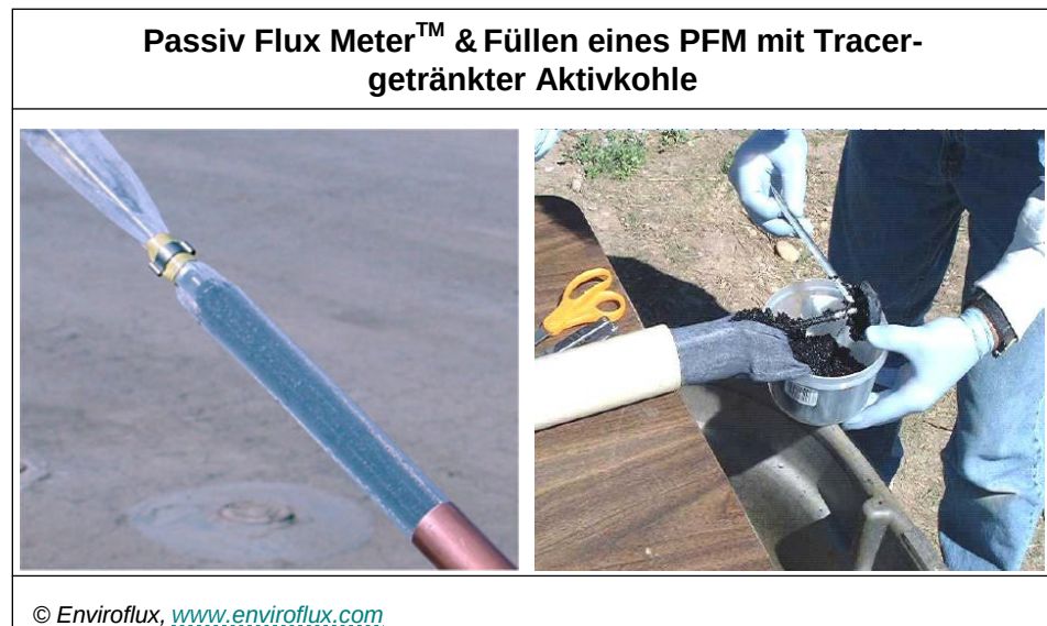
Abbildung 29: links: Passiv Flux Meter™ (PFM), rechts: Füllen eines PFM mit Tracer-getränkter Aktivkohle.
