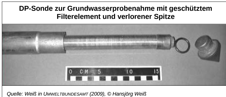
Abbildung 9: DP-Sonde zur Grundwasserprobenahme mit geschütztem Filterelement und verllorener Spitze.
