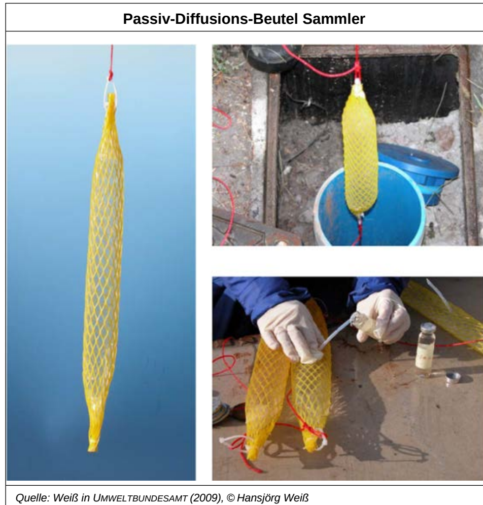
Abbildung 27: Passiv-Diffusions-Beutel Sammler. PE-Schlauch, \varnothing = 3\text{--}5\text{ cm} \times l = 30\text{--}50\text{ cm} , gefüllt mit deionisiertem Wasser (ca. 300 ml).
