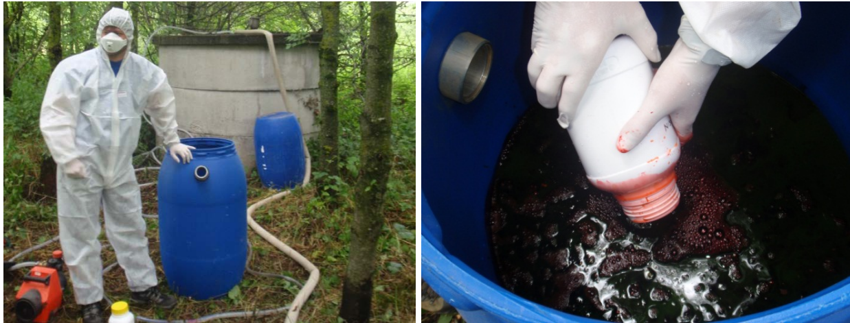
Abbildung 34: Vorbereitungen zur Einspeisung eines Tracers in einen Schachtbrunnen.
