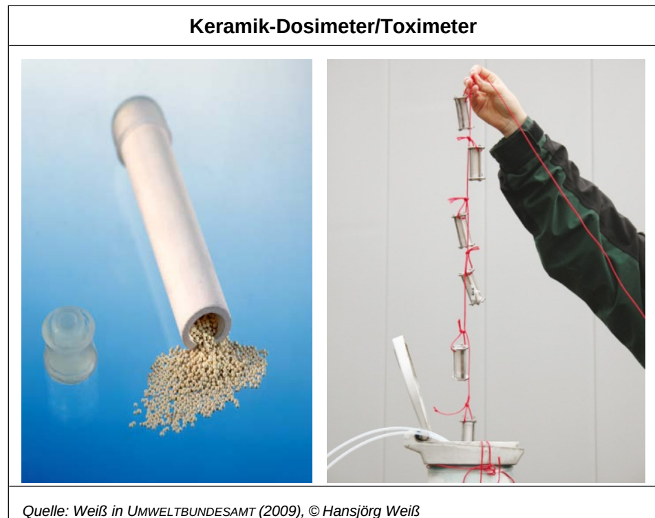
Abbildung 28: Keramik- Dosimeter/Toximeter. links: Keramik-Dosimeter mit Sorbenskugeln (Länge = 10 cm, d = 1 cm), und Teflon- Decke rechts: Einbau in Schutzkäfigen in eine Messstelle.
