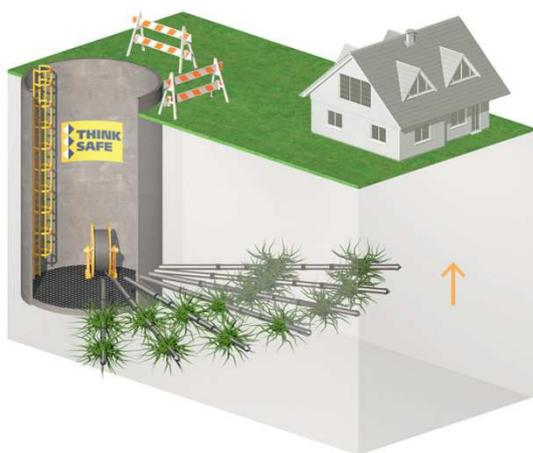
**Abb.2: Wirkungsschema einer Setzungsrückstellung**
