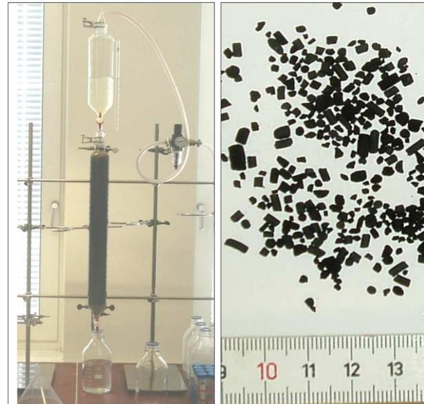
Abbildung 3: Aktivkohlesäule, Aktivkohlegranulat
