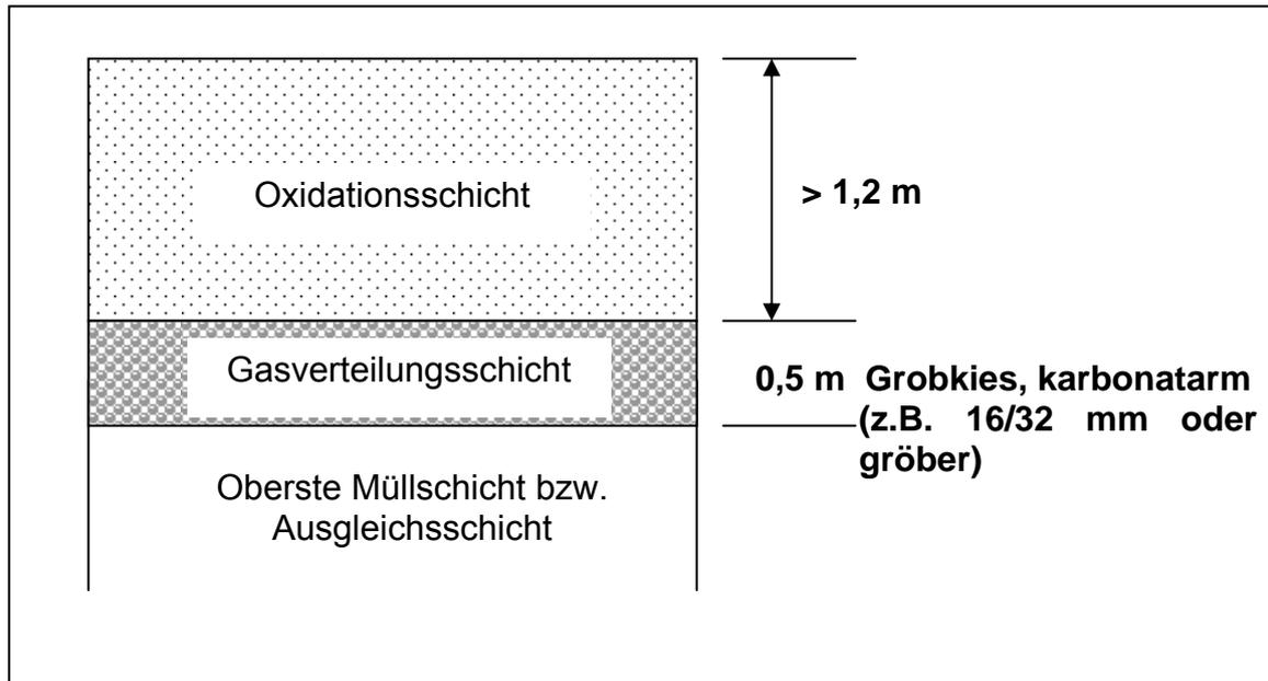
Abbildung 2. Schema einer Methanoxidationsschicht
